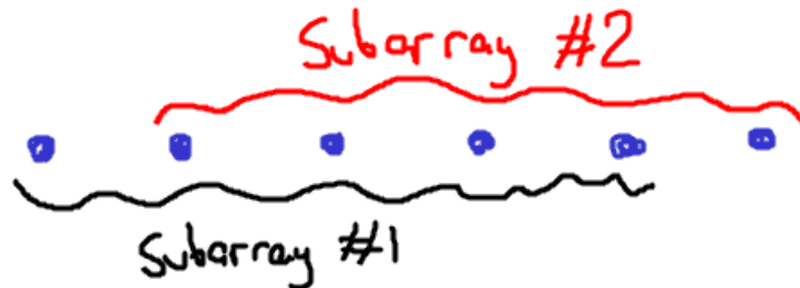
FIGURE 47.2. Subarrays for ULA
